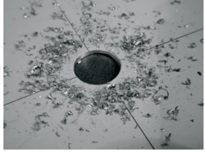
Figura 4.22: Taladrar el agujero en la placa de metal.
