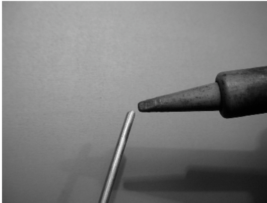
Figura 4.38: Estaño el extremo del alambre antes de soldarlo.
