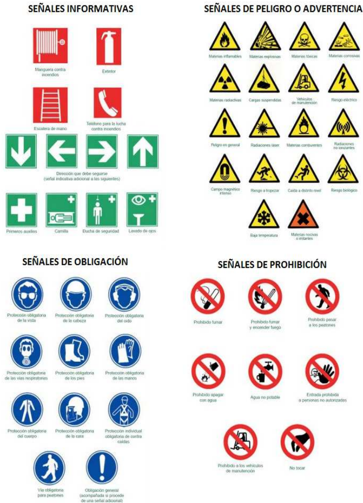
Figura7. Señales de seguridad
