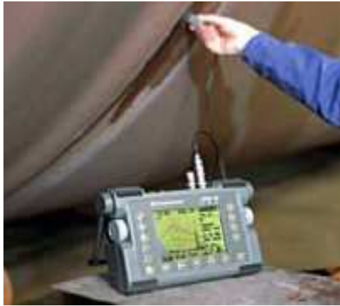
Figura 5. Análisis de fisura por ultrasonido
