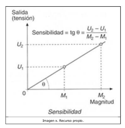
La sensibilidad de un aparato será tanto mayor cuanto mayor sea la diferencia entre los valores de la magnitud eléctrica de trabajo, para una misma diferencia de valores de magnitud física de entrada (medida por el sensor).
