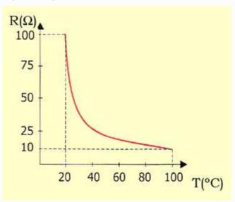
Determinar si la bomba funcionará a temperatura ambiente y cuando la temperatura suba hasta los 100°C.
