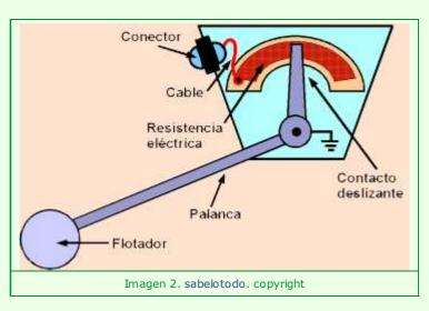
Esta resistencia se conecta en serie con el indicador del tablero, de forma tal que el circuito se cierra a tierra por la vía resistencia => palanca de flotador => cuerpo del sensor => cuerpo del depósito.
